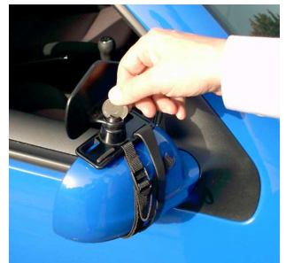
3. Das obere Haltesystem mit dem Spiegel über die obere Kante des Fahrzeugrückspiegels schieben. Bei Erstmontage das Gummihaltesystem auf richtige Länge einstellen, damit ein fester Halt gewährleistet ist.
